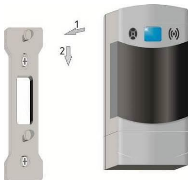
Рисунок 3 – Установка сигнализатора на монтажную панель
